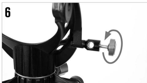
找到 U 形托架侧面的微调杆导向器，松开导向器的固定螺丝，直到固定螺丝不影响微调杆活动。
