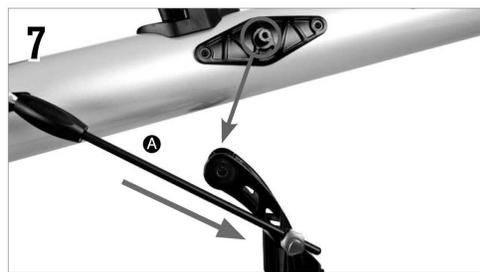
抓住望远镜镜筒，放在 U 形托架上方，把微调杆插入导向器孔内。再慢慢的放低镜筒到 U 形托架中间，把镜筒两侧的螺丝孔对齐 U 形托架的螺丝孔。
