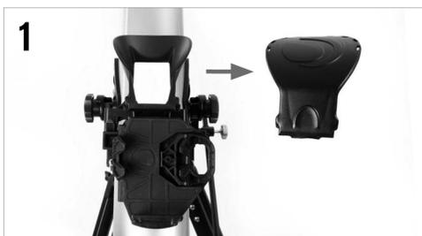
1 移除 StarSense 手机支架前面的反光镜盖。
