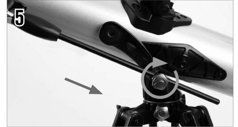
高度角微调范围大约 15 度。如果用户调节到行程的极限，就无法继续转动。用户可以松开微调杆，转动微调旋钮到中间位置，重新固定住微调杆。
