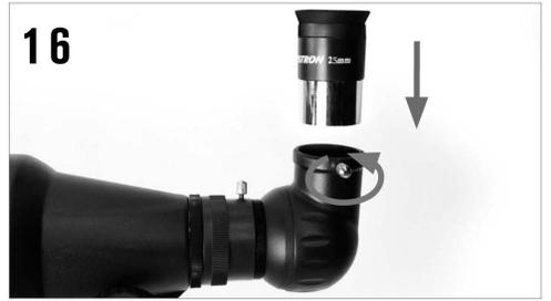
16 松开天顶镜开口端的锁紧螺丝，直到不在内筒露出。把焦距较长目镜的银色筒子插入天顶镜。适度拧紧锁紧螺丝，固定住目镜。为了方便寻找目标，建议从焦距最长的目镜开始观测。
