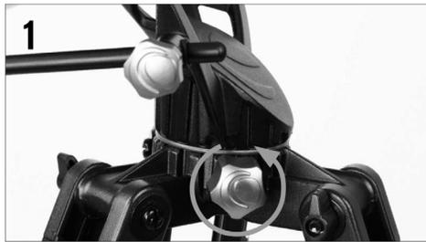
松开三脚架架腿之间的水平锁紧螺丝，可以左右转动望远镜。
