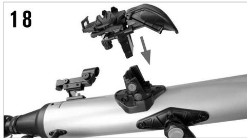
18 松开镜筒上面手机支架底座上的手拧螺丝，把手机支架插入底座，适度拧紧手拧螺丝。
