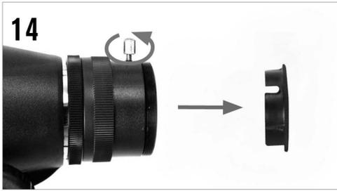
14 移除天顶镜和望远镜后面的所有防尘盖。松开望远镜后面调焦筒上的锁紧螺丝，直到不在内筒露出。
