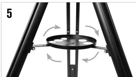
附件盘中间的螺丝朝下，对准张紧架中间的螺丝孔，转动附件盘拧入，直到附件盘完全贴住张紧架。确认三脚架上所有螺丝已适度拧紧。注意：张紧架可能挡住附件盘上的孔，这个是正常的。请使用未挡住的。
