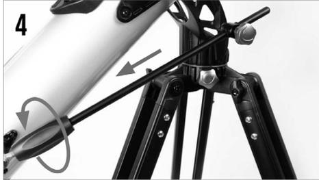
转动微调杆上的微调旋钮可以微调上下方向。保持微调杆导向器固定螺丝锁紧，转动微调杆上的黑色微调旋钮即可。这样可以让用户把目标放在视野中心，或者跟踪天体目标。
