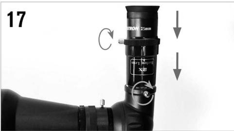
17 要使用增倍镜，用户需要先从天顶镜上移除目镜，然后把增倍镜比较细的一端插入天顶镜，接着把目镜插入增倍镜的另外一段。使用 2X 增倍镜会使倍率提升到原来的 2 倍。
